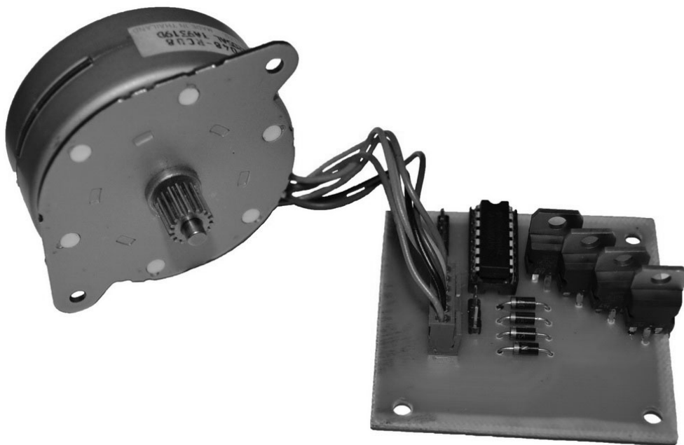
Рисуніок 8. – Шаговы дыягатель і кантраляер у зборы
