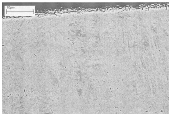
Рисунок 3 – Поперечное сечение фольг сплава Bi – 0.5 ат. % Cu
