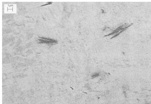
Рисунок 3 – Поперечное сечение фольг сплава Bi – 0.5 ат. % Cu
