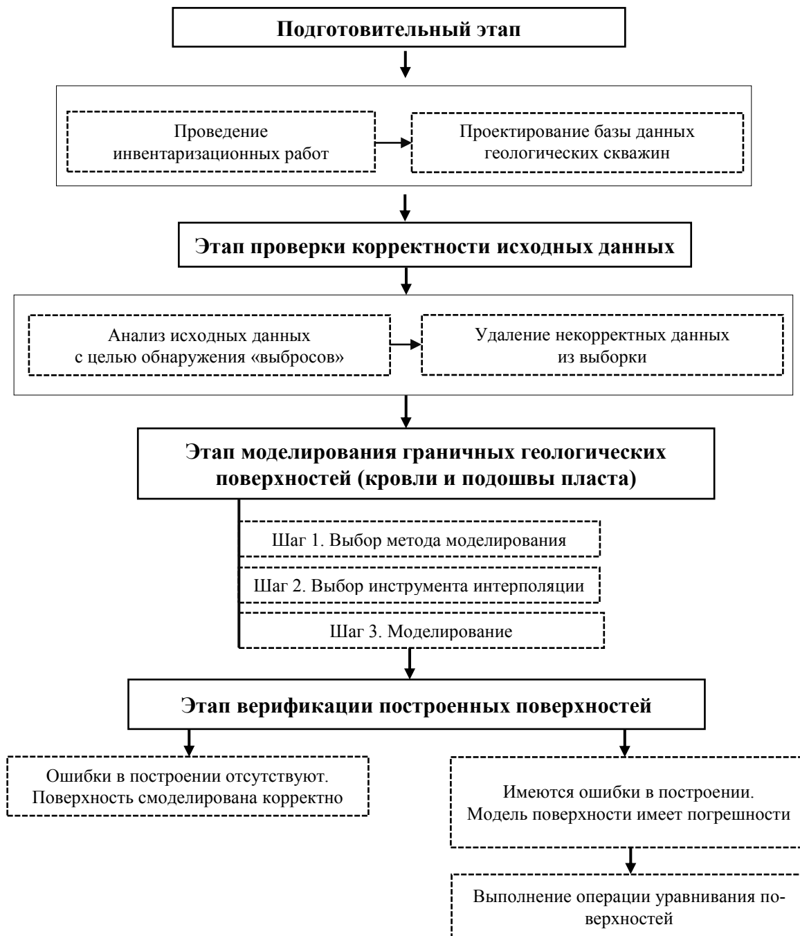
Рисунок 1. – Алгоритм, предусматривающий последовательность обработки данных, отражающих результаты геологических изысканий
