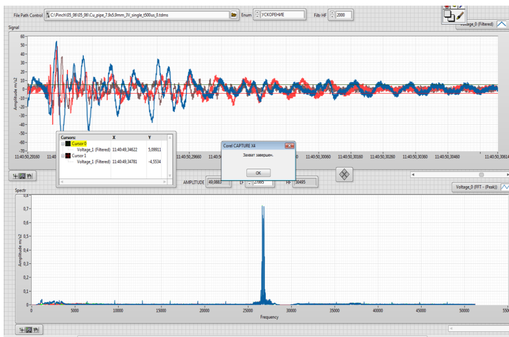
Рисунок 1. – Переходные процессы ультразвуковой вибрации от действия импульсов тока в условиях деформации выше предела текучести
